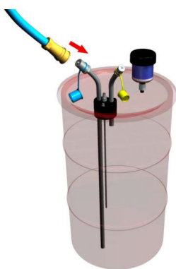
Fig. 10 Tambor con accesorios para control de contaminación en 3D
